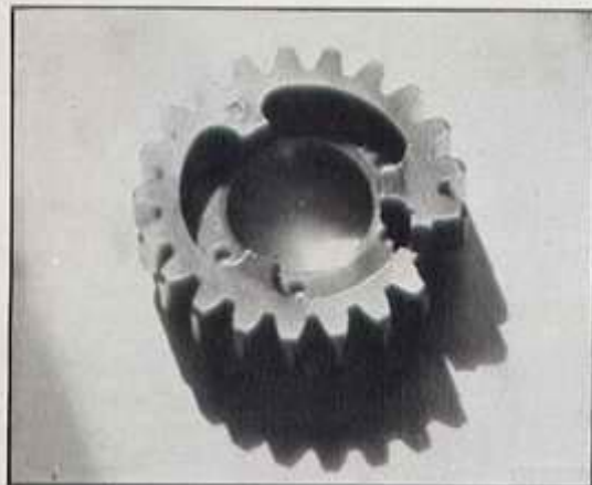
Un problema recalcitrante: la rotura del piñón de tercera.
