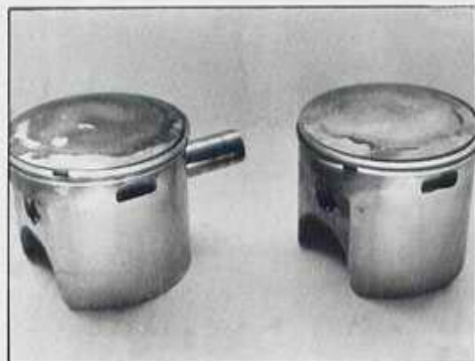
A la izquierda, con el bulón saliendo, el pistón que se monta actualmente y que ha eliminado los gripajes que ocasionaba el antiguo, derecha.
