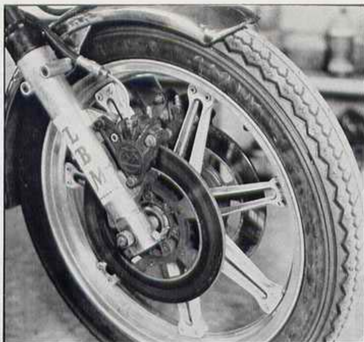
Los discos de freno tienen la mala costumbre de agrietarse por la zona de sus anclajes.
