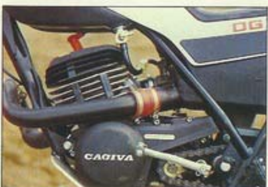
DG 7. Motor: procedencia Cagiva, 124,63 c.c., y admisión por láminas.
