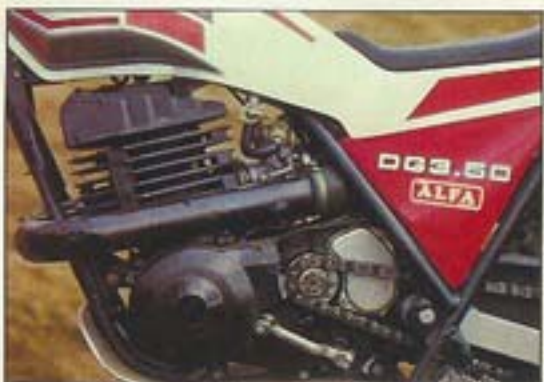
DG 3. Motor: procedencia Cagiva, 346,83 c.c., y admisión convencional.
