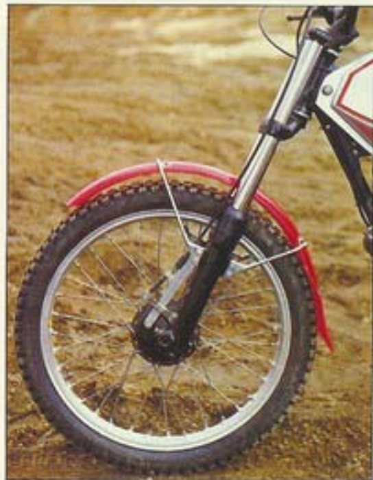
DG 3. Tren delantero: horquilla Betor, barras de 38, y 173 mm. de recorrido.
