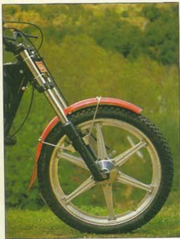
La horquilla Betor que llevaba la moto de pruebas será sustituida por una Telesco con regulación externa del hidráulico.
