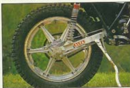
La suspensión posterior no ha sido objeto de transformación, conservándose la solución clásica de dos amortiguadores.
