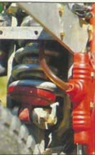
Este es el nuevo sistema «mono» ideado para la suspensión posterior que recibe el nombre de FIUS —Fully Integrated Unishock System—. El amortiguador, de la marca Telesco, va muy vertical.
