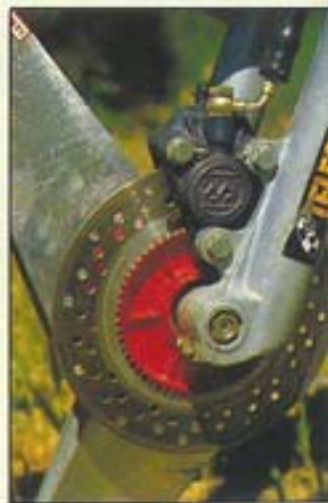
Discos flotantes en los dos trenes de la Merlin y ruedas de tres paños, que se combinan con el uso de neumáticos Michelin sin cámara. La horquilla delantera es la nueva Telesco con barras de 35 mm.
