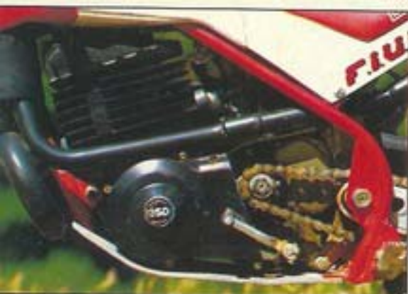
Voluminoso motor Cagiva —346,83 c.c.— con algunos retoques y escape nuevo.
