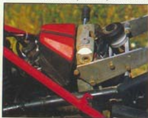
Este es el nuevo sistema «mono» ideado para la suspensión posterior que recibe el nombre de FIUS —Fully Integrated Unishock System—. El amortiguador, de la marca Telesco, va muy vertical.
